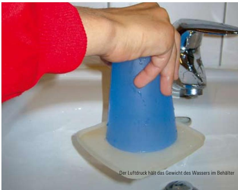
Der Luftdruck hält das Gewicht des Wassers im Behälter
